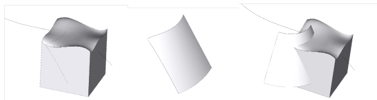
图 2 包含线框、面片和实体区域模型的布尔并/交/差示例
