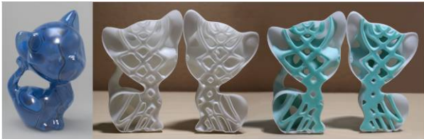
图 11 在 TPMS 内注入材料(淡蓝色)提升结构强度 [61]
