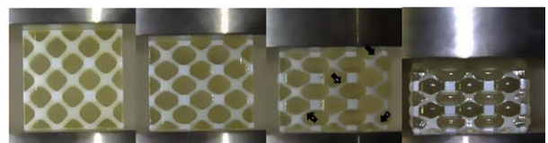
图 4 基于 I-WP 类型双组分结构压缩实验 [28]
